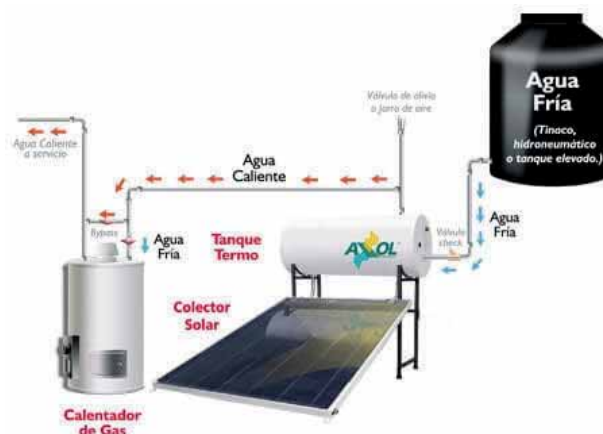
Figura 1 Esquema que representa al modelo de instalación propuesto. Tomado de Mexlight.com.
